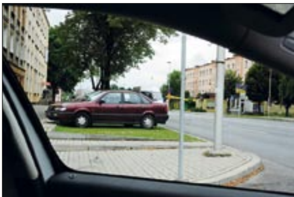
Rys. 1. Ograniczenie widoczności przez parking zlokalizowany zbyt blisko skrzyżowania
