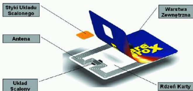
Rys.1. Przykładowa budowa karty typu Mifare.
