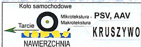
Rys. 12. Polerowalność kruszyw, a bezpieczeństwo ruchu pojazdów.
