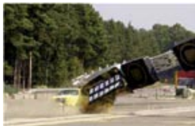
Zdjęcie 5 i 6 Zachowanie się rygla po uderzeniu w drugi słup podpierający i w uderzenie w leżący rygiel.
