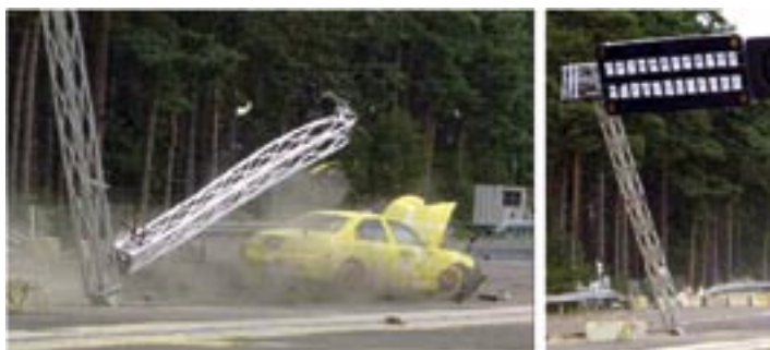
Zdjęcie 4 Zachowanie się słupa i rygla po uderzeniu w pierwszy słup.
