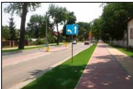
Po lewej : wjazd z pasa dla rowerów na drogę dla rowerów wzdłuż DW 824, po prawej : uporządkowany przekrój DW 824 (m.in. chodnik oddzielony krawężnikiem od drogi dla rowerów).
