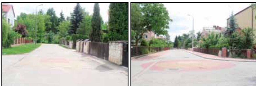
Po lewej : „poduszka” na skrzyżowaniu teowym w dzielnicy Włostowice, po prawej : „pinezka” na skrzyżowaniu czterowłotowym.
