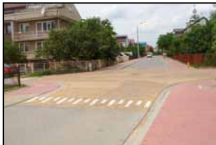
Po lewej : wyniesiona tarcza skrzyżowania czterowłotowego, po prawej : próg przyjazny autobusom.
