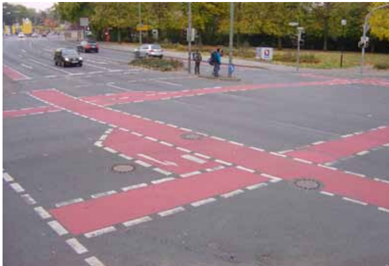
Rysunek 1. Pasy ruchu i śluzy dla rowerów skręcających w lewo w dwóch etapach w Osnabrück (Niemcy). Fot. Marcin Jackowski, www.zm.org.pl
