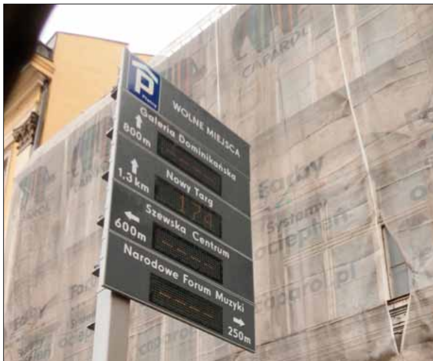
Tablica informacyjna parkingowa na ul. Kazimierza Wielkiego pomiędzy ul. Krupniczą a ul. Zamkowa – TIP 004 w ujęciu w ciągu dnia oraz przy zachodzie słońca – dobra widoczność po zmroku. Wymiary tablicy zmiennej treści – moduł 1450 mm*420 mm* 5 elementów = 2100 mm, górna krawędź na wys. 5220 mm dolna na wys. 3500 mm
