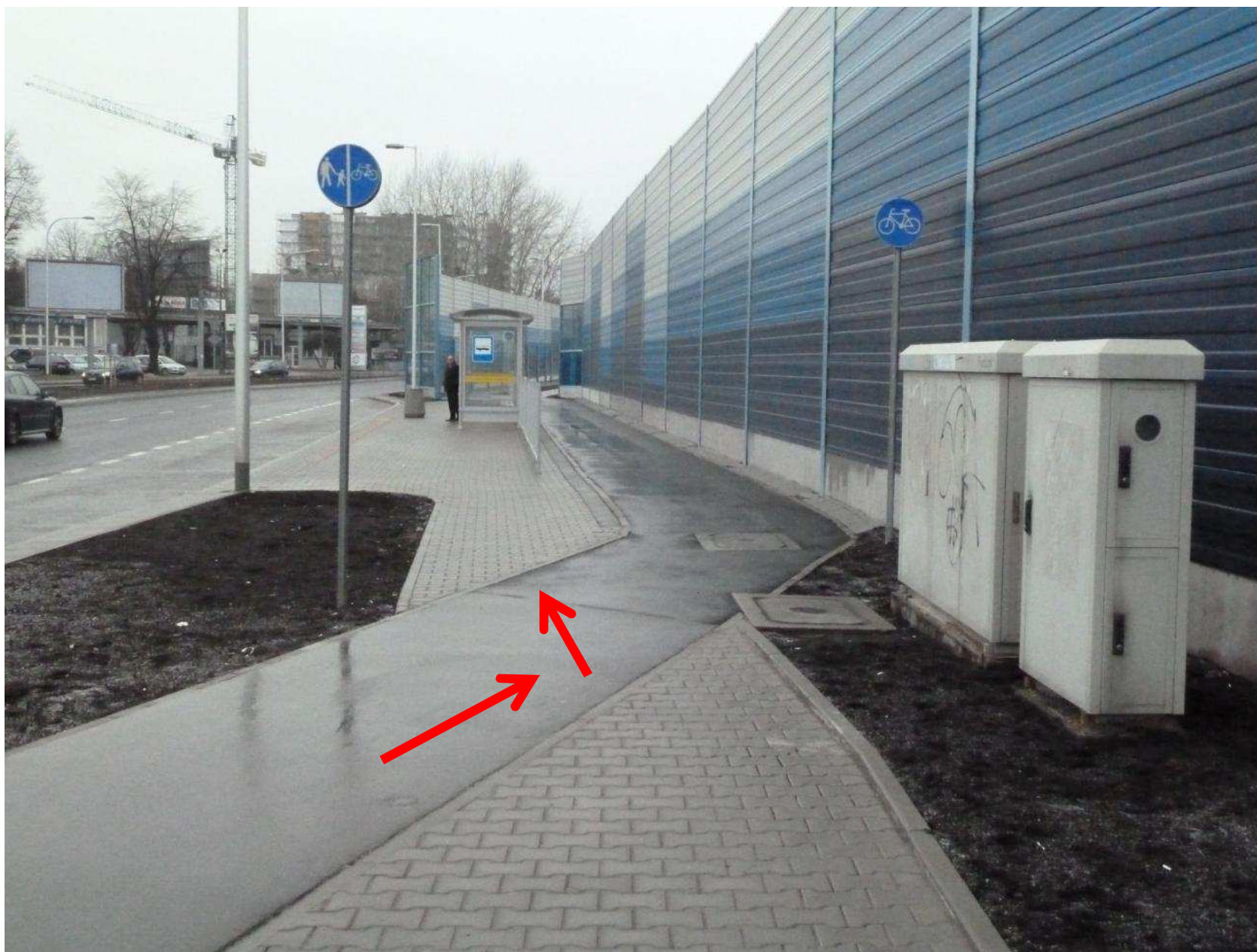
Przecięcie chodnika pod niebezpiecznym kątem - rowerem w bok pieszego !
