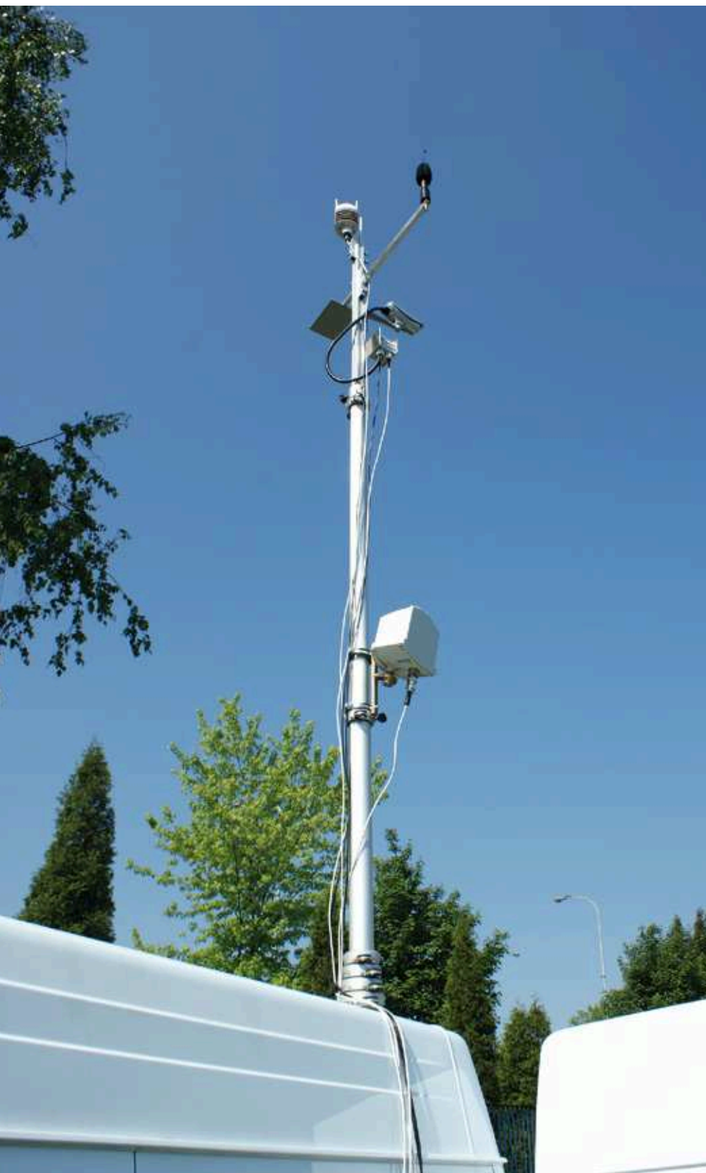
Przenośny zestaw do pomiaru natężenia ruchu
