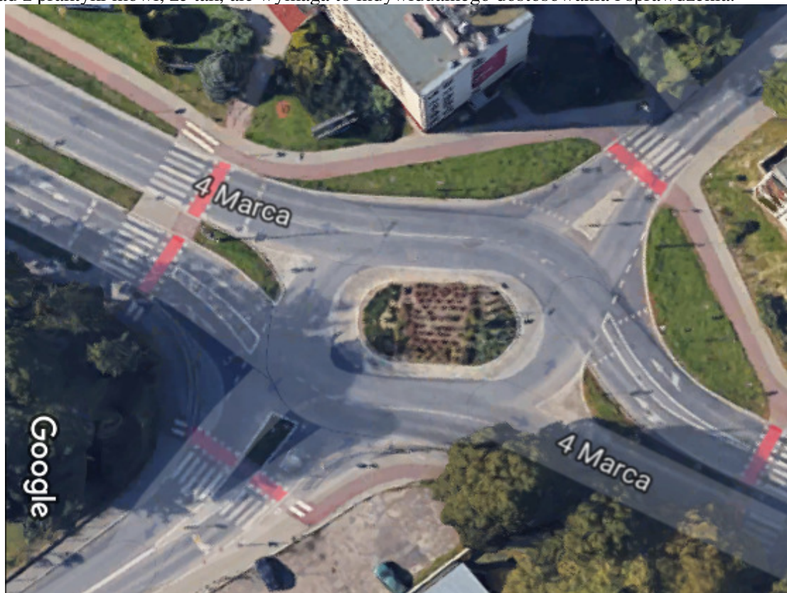
Rys.34.a Rondo kierunkowe w Koszalinie o średnicy zewnętrznej 29,0m / 35,0m. Dwa pasy ruchu na wlotach bardziej obciążonej ul. 4-go Marca, wloty jednopasowe na ul. Wojska Polskiego. (2012)
